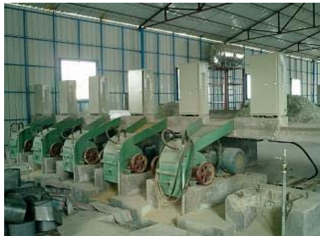
▲以人工將廢印刷電路板推入破碎機粉碎
