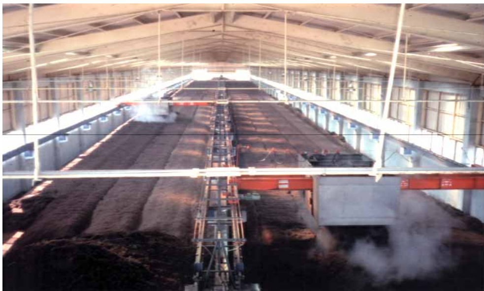
圖 5.18 C 廠利用翻堆機製作堆肥情形
