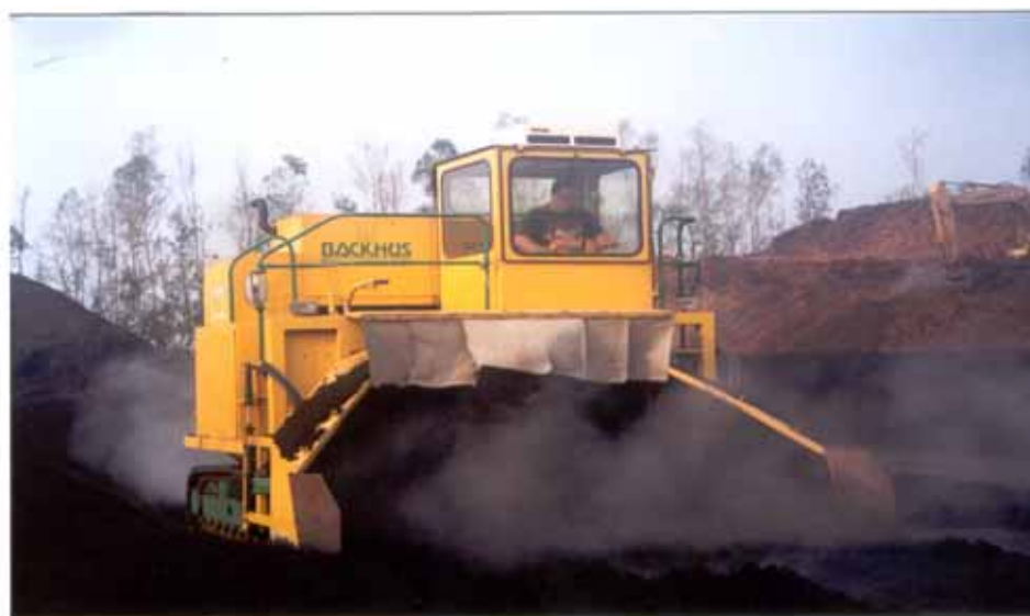
圖 5.17 C 廠露天堆積翻堆情形
