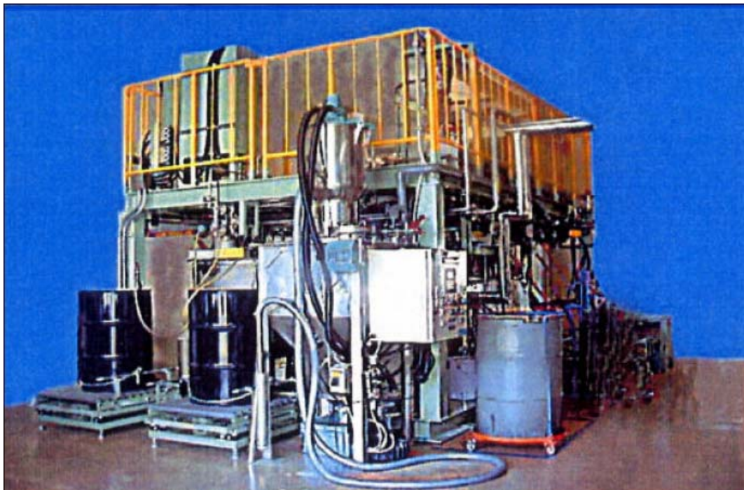
圖 6.3-2 線切割機之切削劑回收系統
