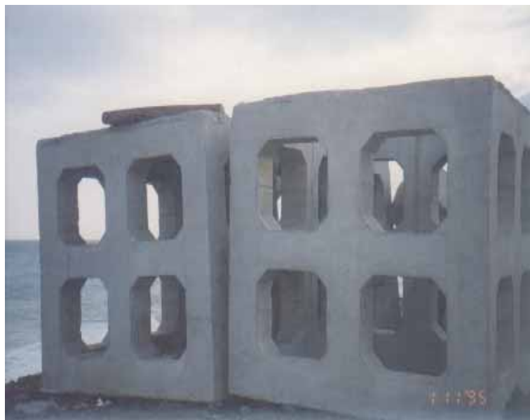
圖 7.11 花崗石污泥固化再生的人工魚礁
