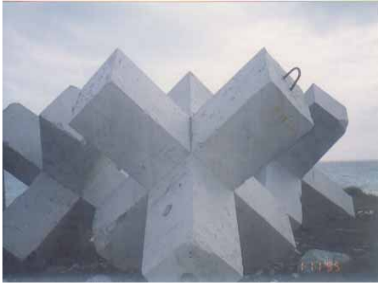
圖 7.12 花崗石污泥固化再生的人工魚礁支撐架
