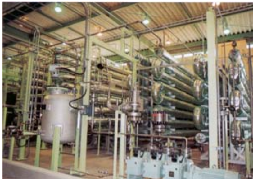
照片 3.6 SCWO 超臨界水濕式氧化技術處理下水污泥 之實廠現勘(處理量 1.1\text{m}^3/\text{hr} )
