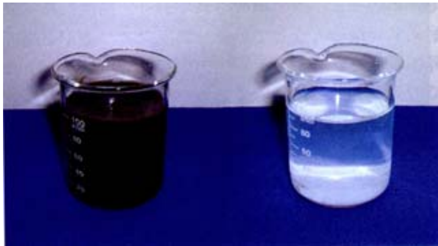
照片 3.5 SCWO 處理下水污泥之效果： 左邊為下水污泥，右邊為處理後之出流水
