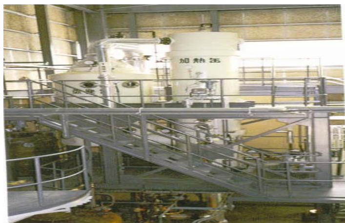
圖 5.11 多重效用罐蒸發濃縮裝置構造圖
