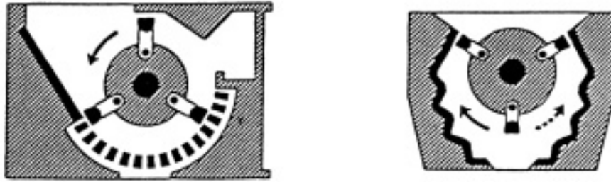
圖 5.4 衝擊破碎機型式之示意圖
