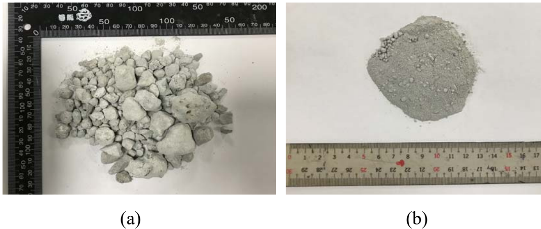
圖 2-5 安定化後還原渣(石)(a)研磨前；(b)研磨後
