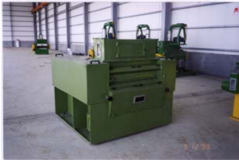
圖 7.3 廢塑膠破碎分離處理設備
