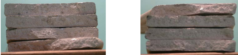
圖 7.10 X 廠商回收錠之 K-Mould 破斷面
