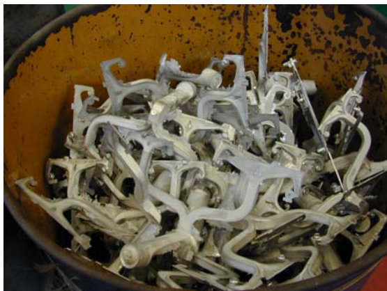
圖 3.2 鎂合金廢棄物 1A(左圖)及 1B 級
