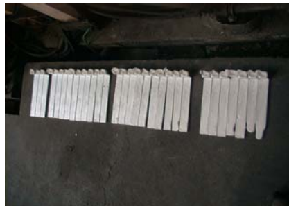
圖 7.11 X 廠商回收錠之 K-Mould 流動長度
