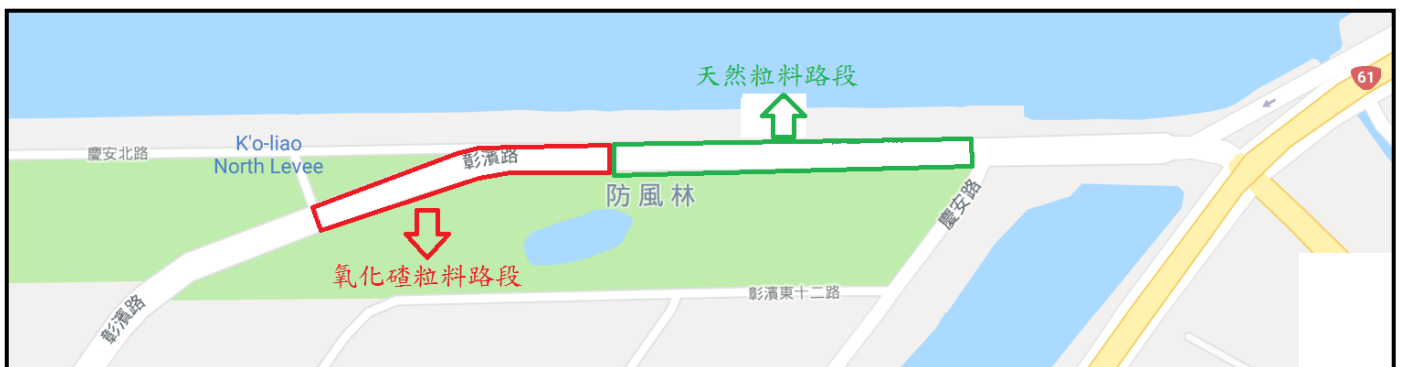
圖 8-12 彰濱工業區彰濱路氧化矽瀝青混凝土試鋪工區示意圖
