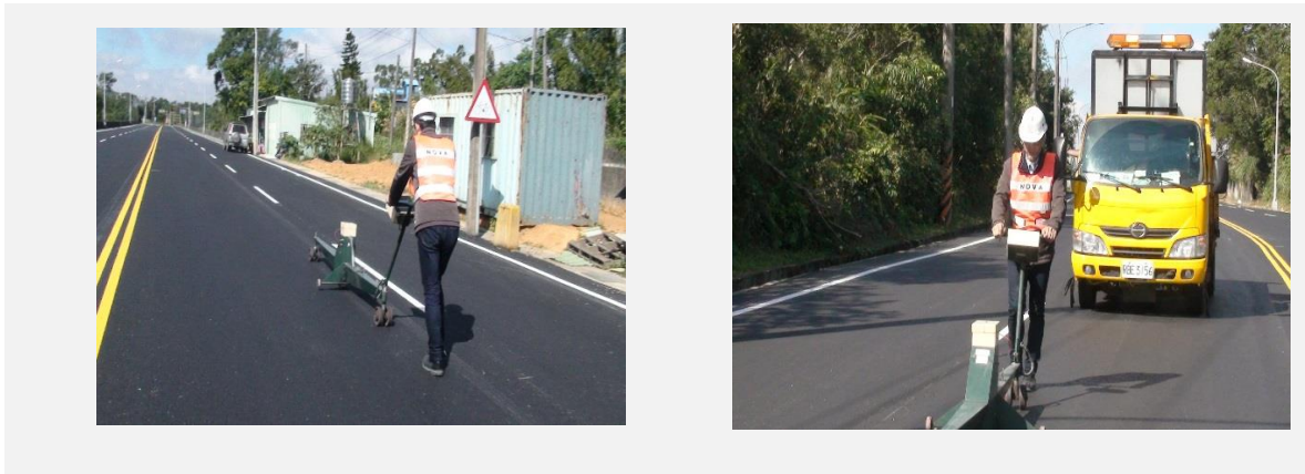
圖 8-4 平坦度試驗(桃 68-1 線) [12]
