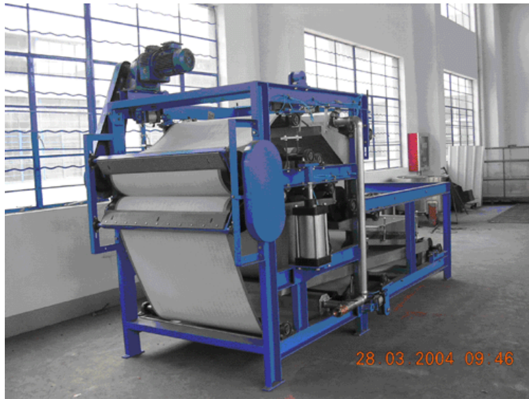
圖 3.107 典型帶濾式脫水機之外觀
