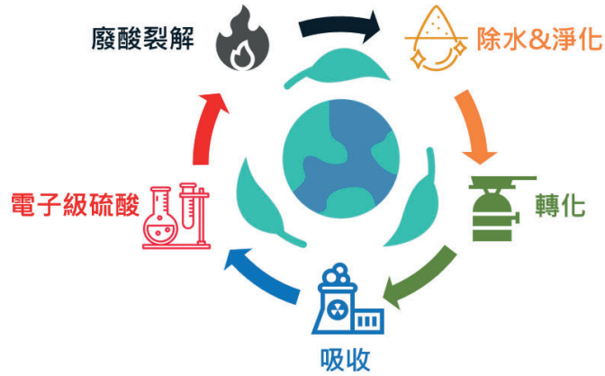
圖 2.2-3 強方科技廢硫酸製成電子級硫酸之製造流程
