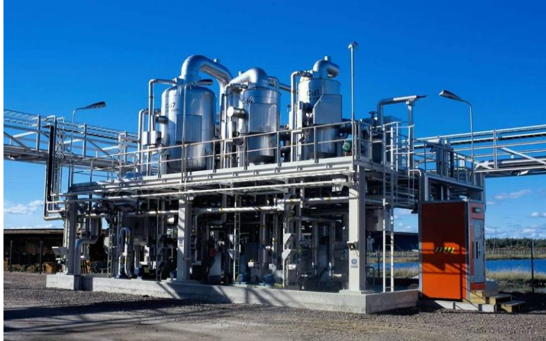
圖 3.1-2 瑞典商阿法拉伐公司多效蒸餾技術應用實例(瑞典 Akzo Nobel)
