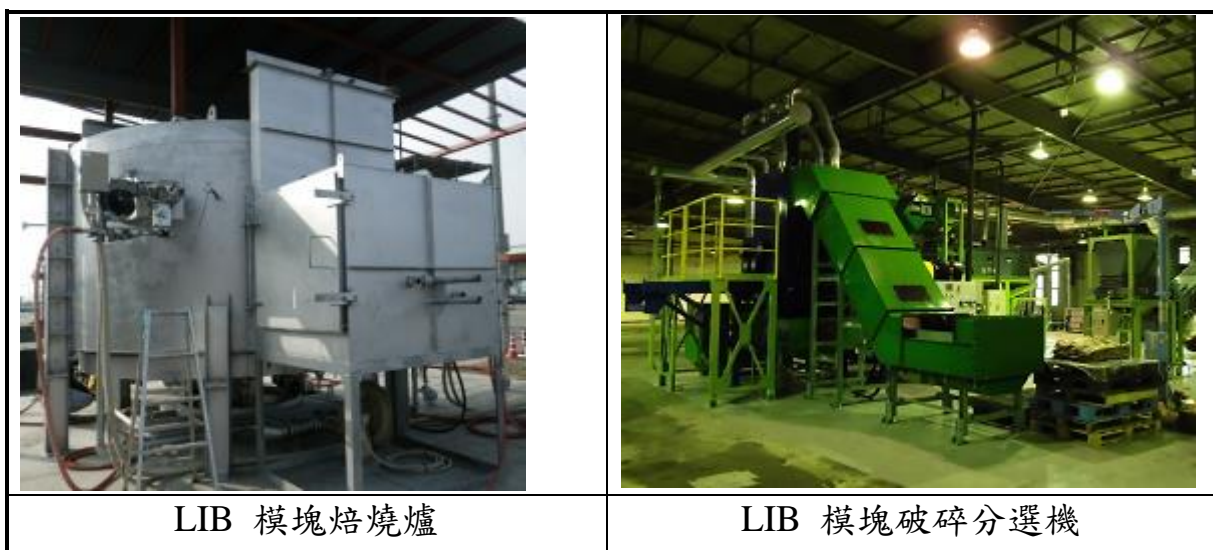
圖 4.1-3 日本太平洋水泥公司焙燒與分選回收處理裝置
