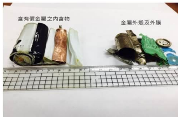
三元系鋰電池內部構造之情形
