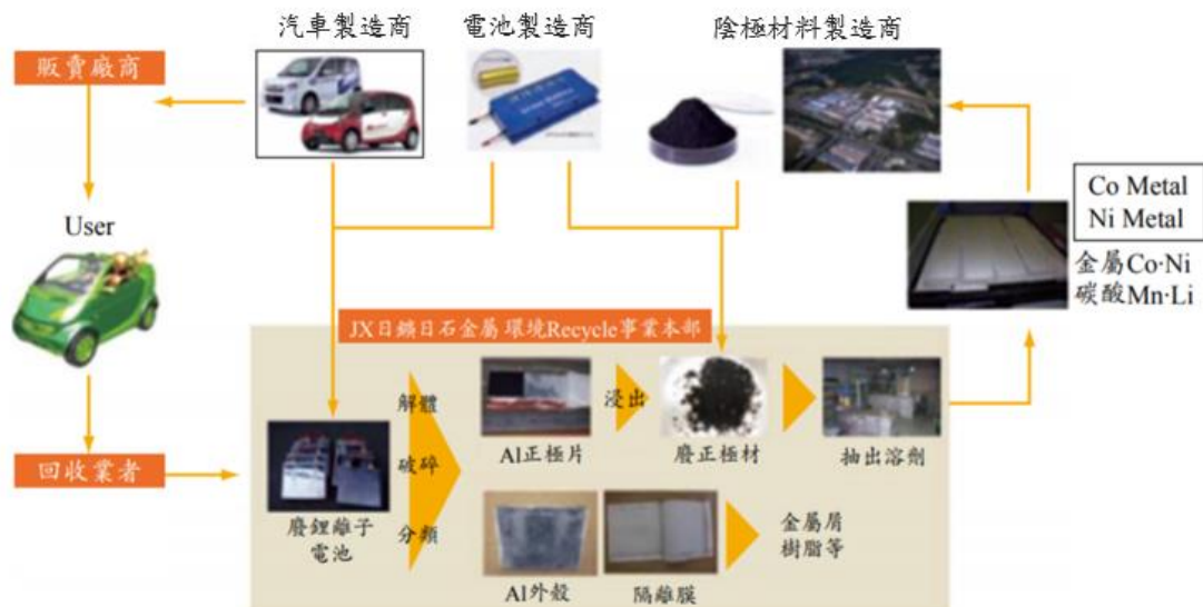
圖 4.3-1 JX 日礦公司廢鋰電池回收程序示意圖
