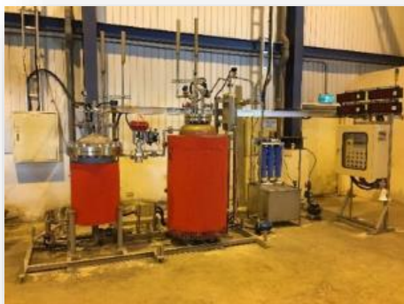
大型高壓蒸鍋 (觀測體積有無爆裂)
