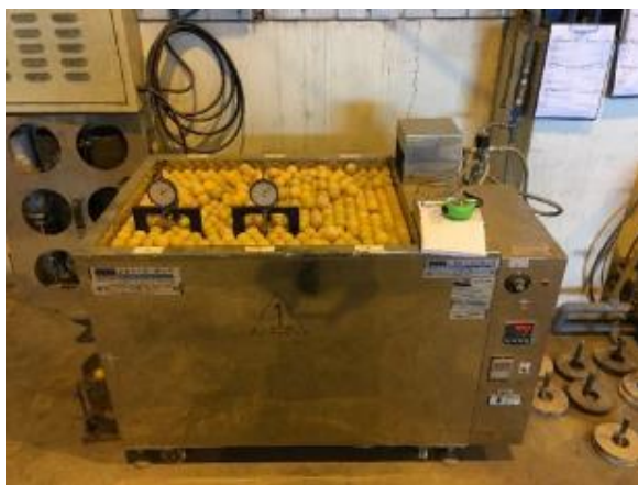
恆溫水槽 (量測體積變化)
