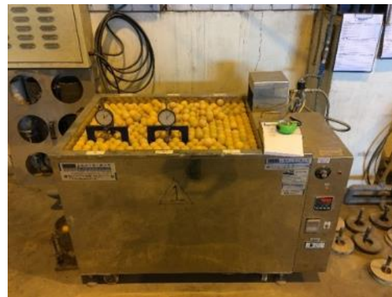
恆溫水槽 (量測體積變化)
