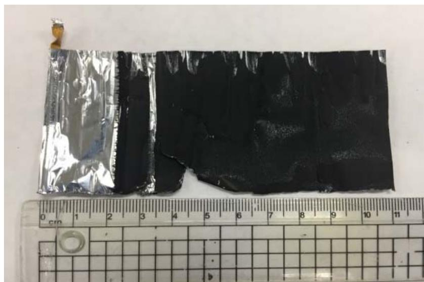
圖 2.本研究拆解廢三元鋰電池(18650)所得之正極外觀
