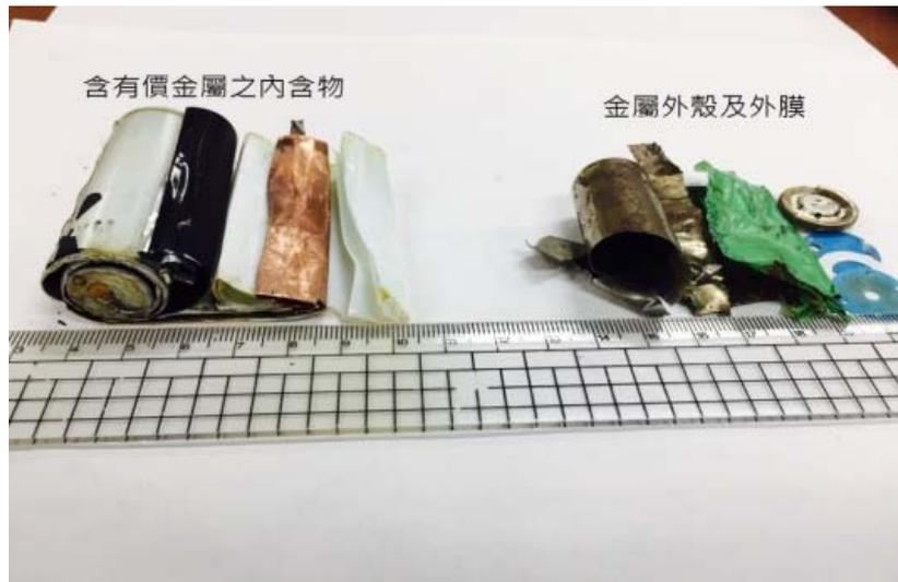
圖 1.本研究拆解廢三元系鋰電池(18650)內部構造之情形
