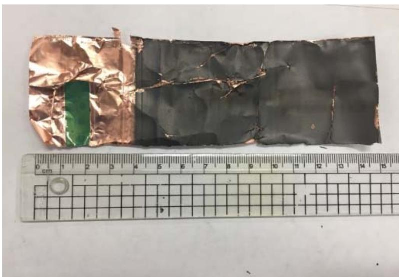
圖 3.本研究拆解廢三元鋰電池(18650)所得之負極外觀
