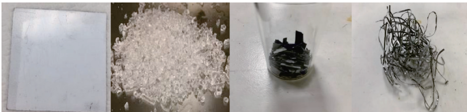
圖 8 經本研究前處理後之背板、鋼化玻璃、太陽能電池片與鍍錫銅帶
