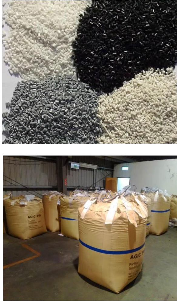
圖 2 PP 再生塑膠粒(上)及裝入太空包之 PP 再生塑膠粒(下)
